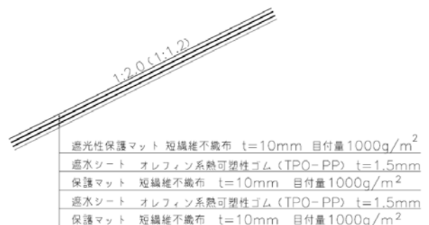
図3-2 遮水構造 (底面部)
