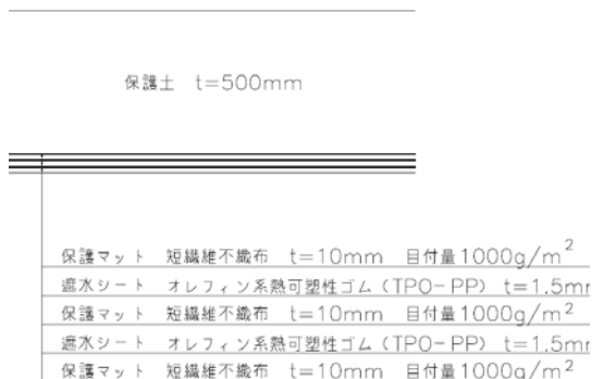
図3-1 遮水構造 (法面部)
